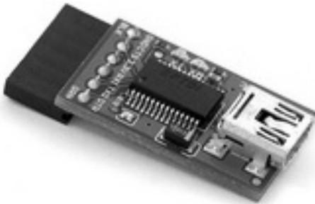
Bild 2.7: USB-Adapter mit FTDI-Chip (Quelle: Elmicro)
