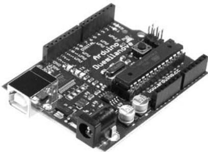
Bild 3.2: Arduino Duemilanove (Quelle: Elmicro)
